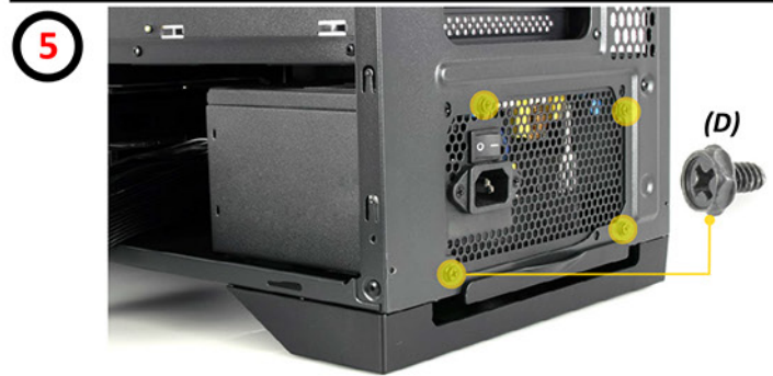
Secure the PSU with (D) or (B) screws
